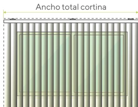
El ancho total de la cortina será la medida que haya entre ambos extremos exteriores del cabezal con tapas incluidas.
