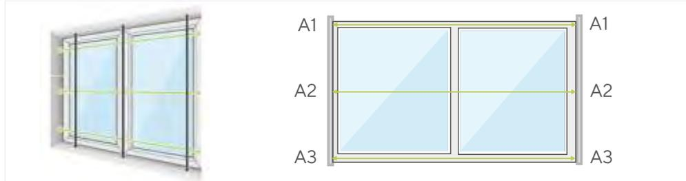
Con una cinta métrica realice la toma de medidas en los puntos A1, A2 y A3 como indica el esquema.
