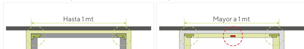
La instalación de los soportes sobre paredes laterales sólo es posible si la cortina mide hasta 1 mt de ancho. Pasada esa medida la instalación debe ser sobre pared de fondo y debe llevar un soporte intermedio.
