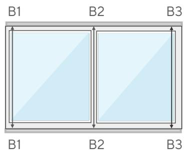
Con una cinta métrica realice la toma de medidas en los puntos B1, B2 y B3 como indica el esquema.
