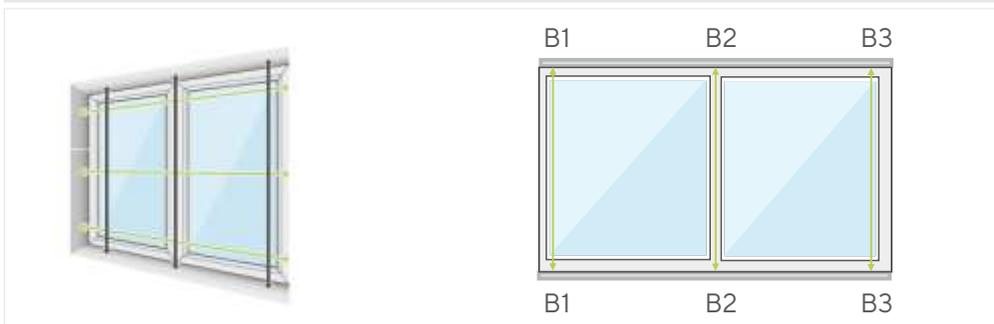
Con una cinta métrica realice la toma de medidas en los puntos B1, B2 y B3 como indica el esquema.
