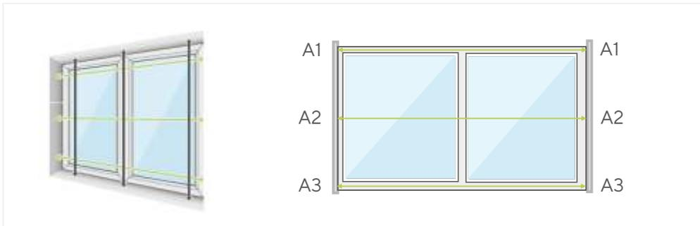
Con una cinta métrica realice la toma de medidas en los puntos A1, A2 y A3 como indica el esquema.
